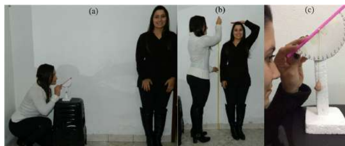
Figura: 3.11. (a) Determinação da altura, com auxílio do teodolito construído. (b) Altura medida com auxílio de trena (c) Ângulo obtido na visada com o teodolito
